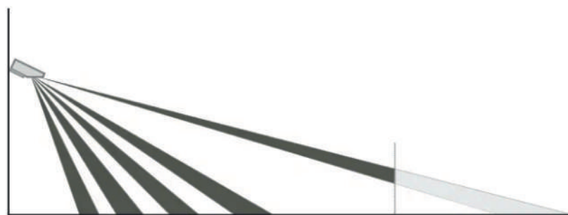
Схема размещения извещателей с веерной диаграммой направленности (вид сбоку)
